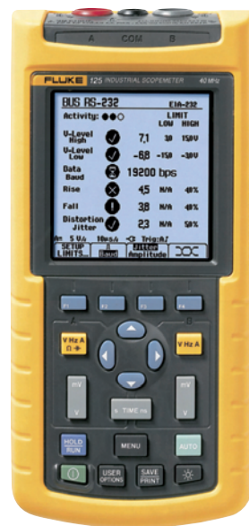
Obr. 3 Osciloskop Fluke F125 v režimu BUS-HEALTH
