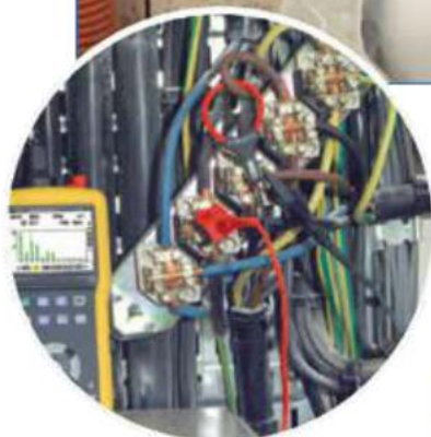
Převodníky AmpFlex při použití s analyzátozem sítě C.A 8335
