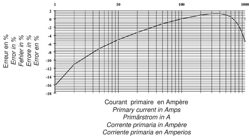
Courbe de déphasage typique en fonction d'un courant primaire alternatif 50 Hz
