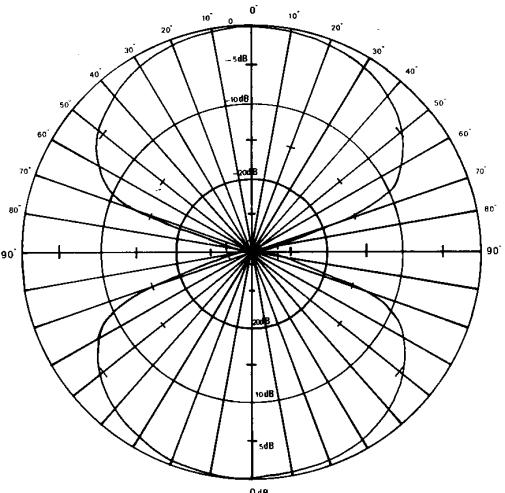
Wegen der Anisotropie der Meßsonde EF1 ist bei einer Messung die Sonde in alle Richtungen und Ebenen zu drehen (siehe Darstellung):
