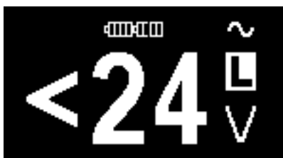
Obr. 3.17a Indikace fáze (stručné zobrazení)
