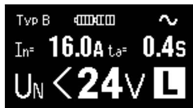
Obr. 3.17b Indikace fáze (podrobné zobrazení)
