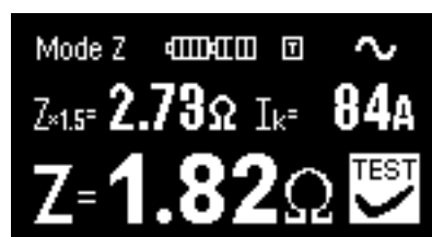
Obr. 3.14 Příklad zobrazení změřené impedance
