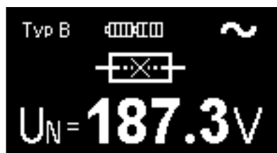
Obr. 3.2 Příklad indikace přerušené pojistky (podrobné zobrazení)
