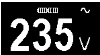
Obr. 3.3a Měření napětí (stručné zobrazení)
