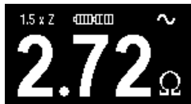
Obr. 3.10 Příklad zobrazení 1,5 násobku změřené impedance
