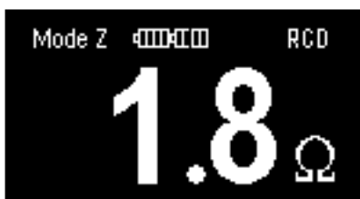
Obr. 3.15a Příklad zobrazení impedance za proudovým chráničem (stručné zobrazení)
