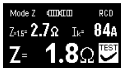
Obr. 3.15b Příklad zobrazení impedance za proudovým chráničem (podrobné zobrazení)
