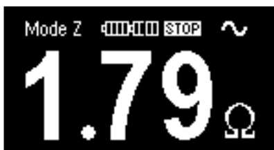
Obr. 3.6a Příklad indikace překročení maximální teploty – symbol STOP
