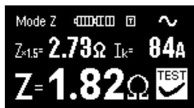
Obr. 3.8b Příklad výsledku měření impedance (podrobné zobrazení)
