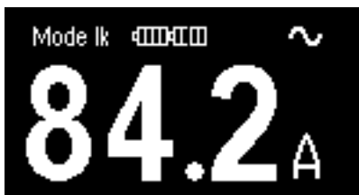
Obr. 3.9 Příklad zobrazení zkratového proudu
