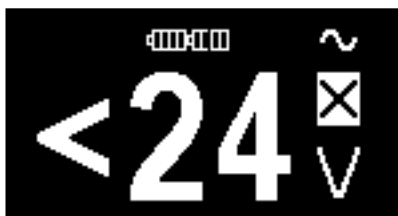
Obr. 3.1a Napětí < 24\text{ V} (stručné zobrazení)
