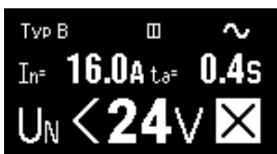
Obr. 3.4a Nízké napětí baterie (podrobné zobrazení)
