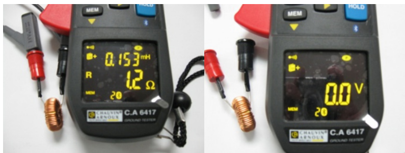
Obr. 3 a 4 Ukázky dalších možností zobrazení: naměřená impedance a dotykové napětí
