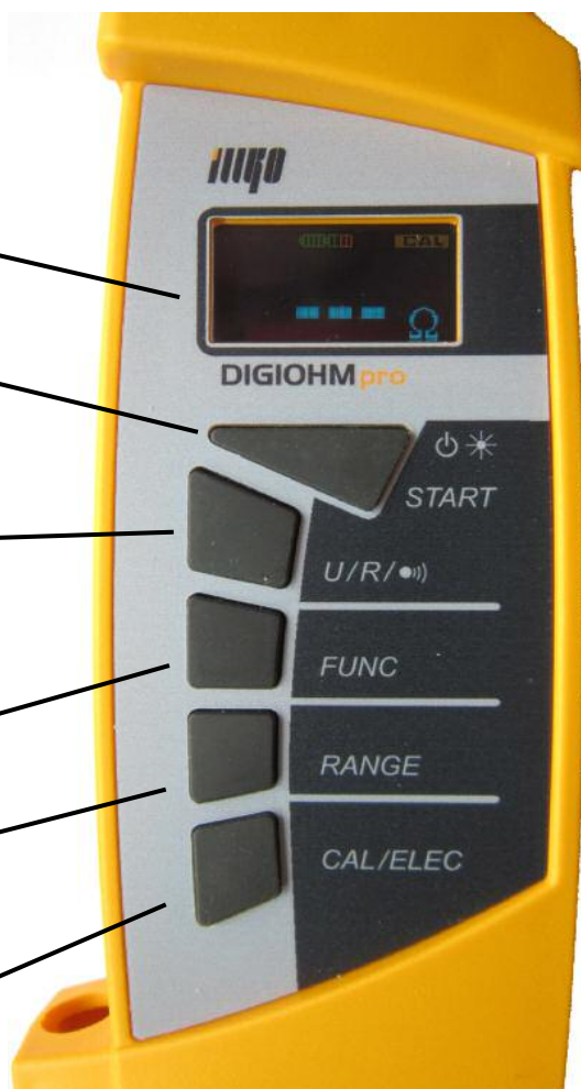
Obr. 2.3. Ovládací panel a OLED displej
