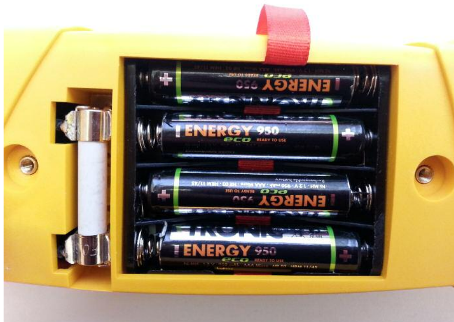
Obr. 4.1 Správná polarita napájecích článků a umístění pojistky
