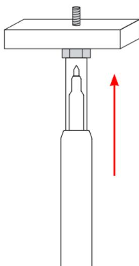
Para realizar una prueba, coloque la punta en el objeto a estudiar y presione para hacer que se deslice la protección.
