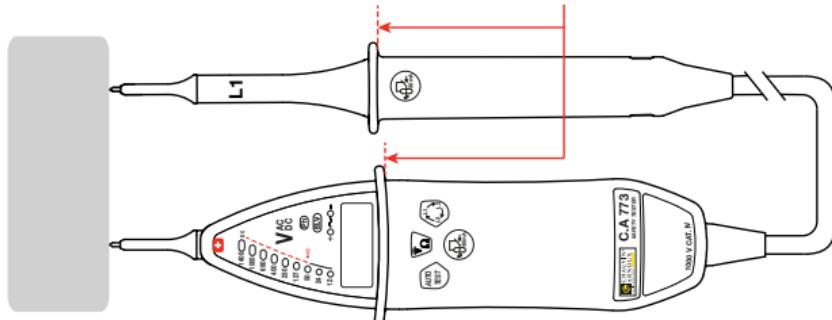
Collocate le punte di contatto sull'elemento da verificare e mantenete saldamente il contatto.
