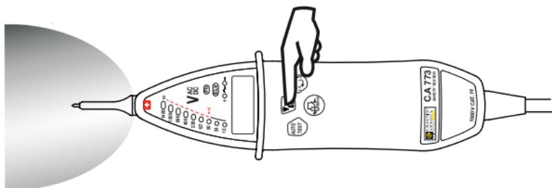
Zum Ausschalten drücken Sie entweder noch einmal auf die Taste bzw. warten Sie, bis das Licht nach etwa 10 Sekunden automatisch erlischt.
