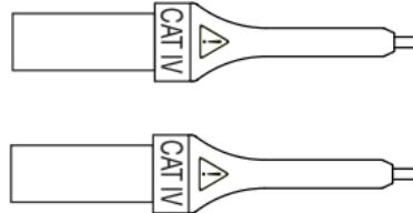
Prüfspitzen Ø 2 x 15 mm (eine rote und eine schwarze) ..... P01102124Z
