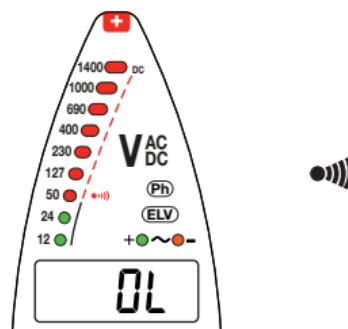
Se si illumina solo la spia **ELV**, le pile sono esaurite o assenti.
