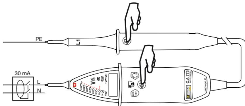
Si la tension mesurée est comprise entre 8 V<sub>eff</sub> et 400 V<sub>eff</sub>, le test est déclenché.
