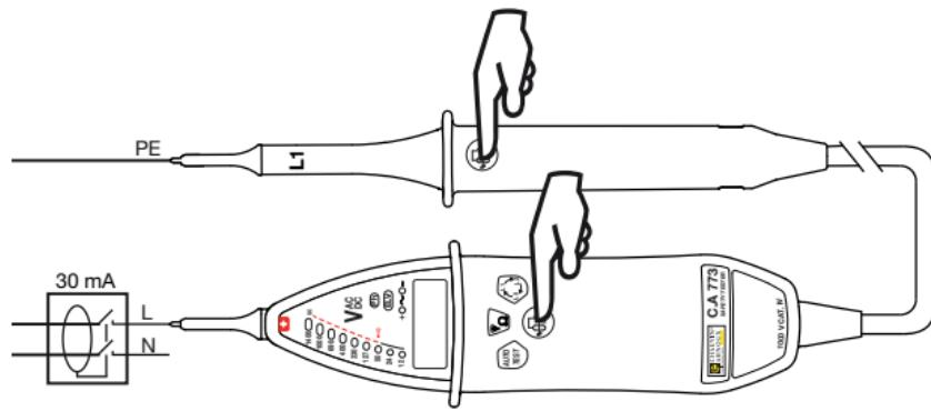
Se la tensione misurata è compresa tra 8 V<sub>eff</sub> e 400 V<sub>eff</sub>, il test viene avviato.
