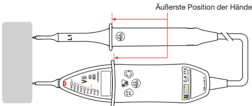
Halten Sie die Prüfspitzen fest an den Prüfling.
