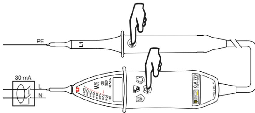
Bei einer Spannung zwischen 8 und 400 VRMS. wird der Test ausgelöst.
