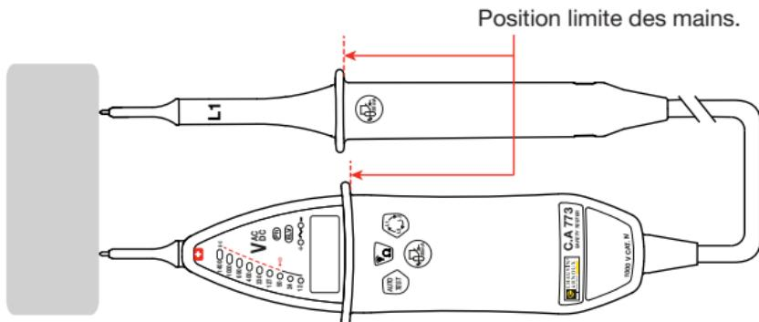
Placez les pointes de touche sur l'élément à tester et maintenez fermement le contact.
