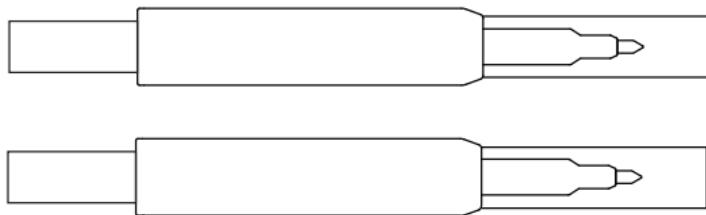
Puntas de prueba roja IP2X de Ø 4 mm (una roja y una negra) ..... P01102128Z
