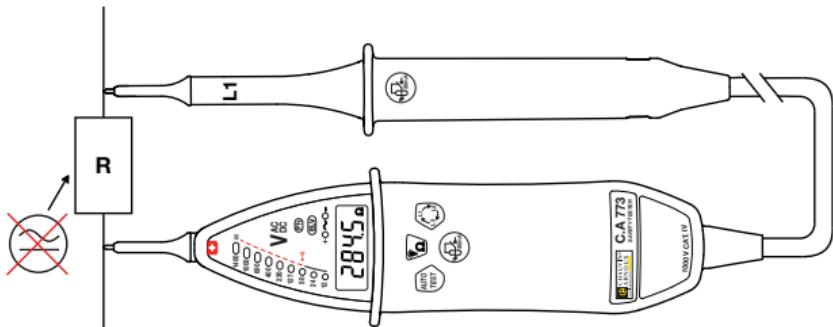
Der C.A 773 nimmt die Durchgangsprüfung vor, wenn keine Spannung vorhanden ist.
