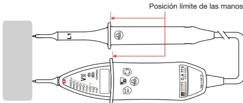
Coloque las puntas de prueba en el elemento que se vaya a comprobar y mantenga el contacto con firmeza.
