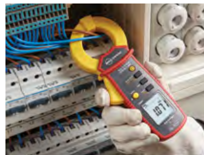
Měření rozdílového proudu s měřením unikajícího proudu klešťovými ampérmetry
