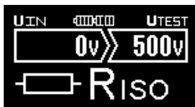
Obr. 3.5 Příklad nastavení pro měření izolačních odporů
