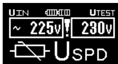
Obr. 3.4b Příklad výsledku měření (zvoleno měření přepětových ochran)
