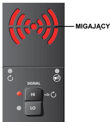
Rysunek 3.1c: Ekran nadajnika pokazuje sygnał w trybie WYSOKI
