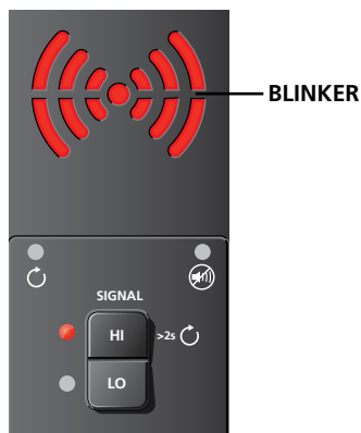
Figur 3.1c: Senderskjermen viser signal i HØY modus
