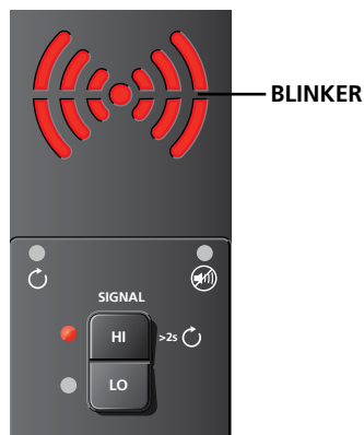
Figur 3.1c: Senderskærm med signal i HØJ tilstand
