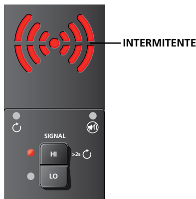
Figura 3.1c: Ecrã do transmissor mostrando sinal no modo ALTO
