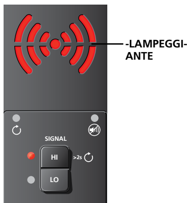
Figura 3.1c: Display del trasmettitore che mostra il segnale in modalità HI
