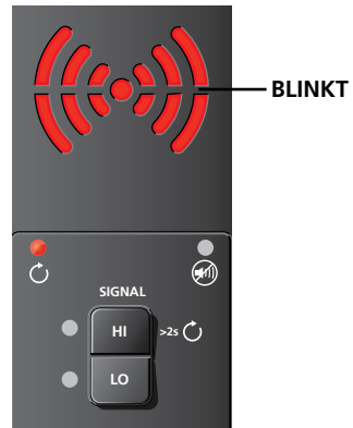
Abbildung 4.12b: Anzeige des Senders im Signalmodus Schleife
