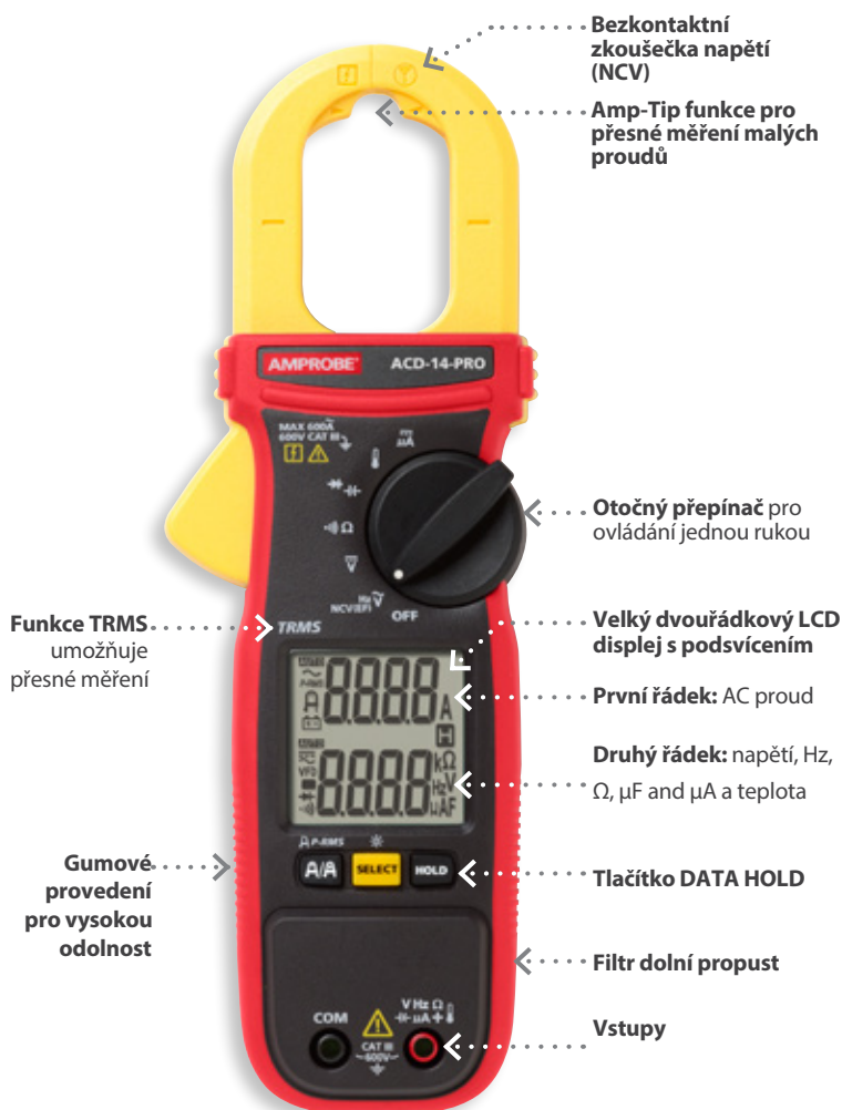
ACD-14-PRO Klešťový TRMS multimetr s dvouřádkovým displejem 600 A
