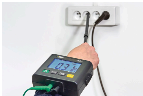
Obr. 4 Praktické umístění testeru na zápěstí
