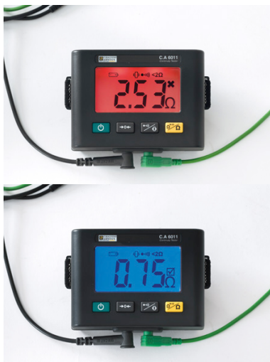
Obr. 1 a Obr. 2 Barevné podsvícení indikuje výsledek testu dle nastaveného limitu
