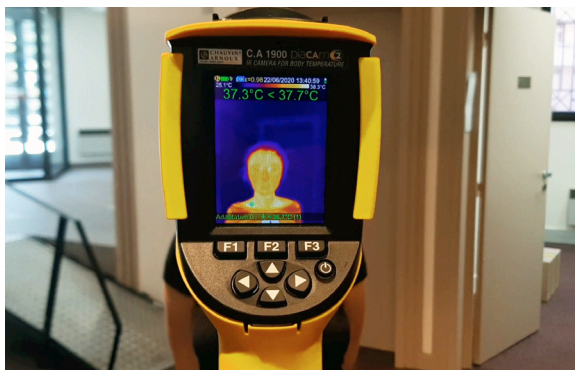
Obr. 4 Relativní měření pomáhá zamezit zkreslení měření vlivem okolního prostředí
