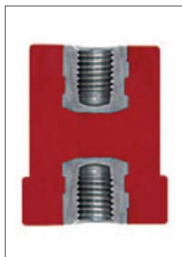
Obr. 2. Řez izolátorem typu CT/P
