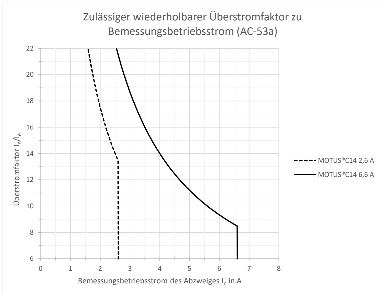
Bild 16 Zulässiger wiederholbarer Überstromfaktor zu Bemessungsbetriebsstrom
