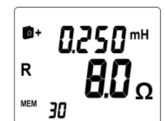
Obr. 6 Proud, impedance, dotykové napětí, odpor a indukčnost ve smyčce, zobrazení data a času měření. Obrazovky se volí opakovaným stisknutím kurzoru.
