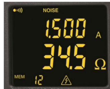
Obr. 3 Na OLED displeji lze vidět hodnotu proudu 1,500 A a naměřený odpor 34,5 Ω. Symbol nebezpečné napětí (blesk) upozorňuje na překročení povoleného dotykového napětí, číslo 12 udává počet naměřených hodnot uložených v paměti, symbol NOICE indikuje rušivý proud v instalaci, symbol akustiky indikuje aktivní akustickou signalizaci.
