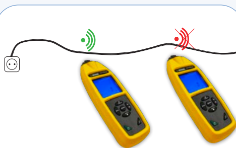
Identifikace síťového napětí a lokalizace přerušení v obvodu
