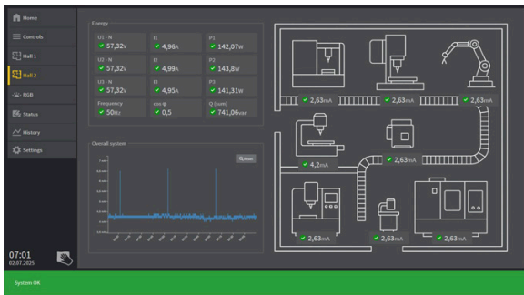
Obr. 5 Příklad vizualizace monitoringu reziduálních proudů ve výrobní lince
