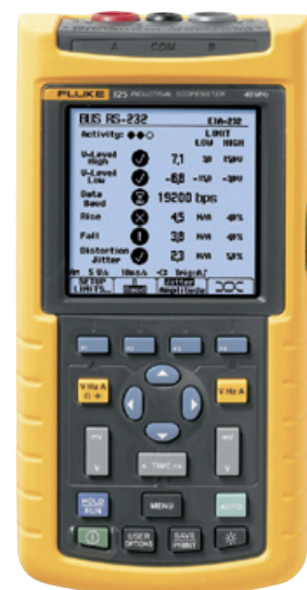
Obr. 3 Osciloskop Fluke F125 v režimu BUS-HEALTH, kontrola stavu sběrnic
