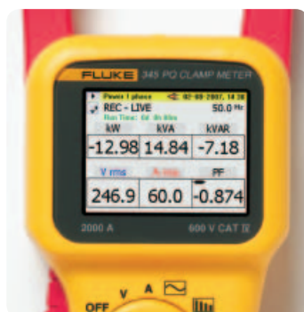
Obr. 2 Ukázka displeje přístroje při měření výkonů
