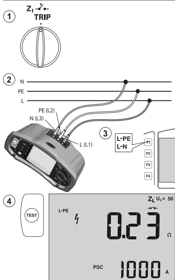
**ΔT / I<sub>ΔN</sub>** RCD · Disjoncteur différentiel · FI
